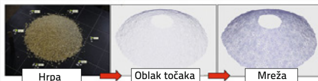
Slika 4. Određivanje kuta sipanja iz 3D modela
