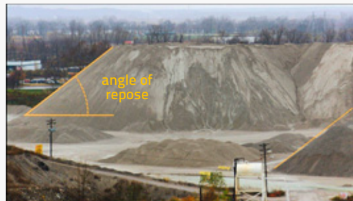
Slika 11. Odlagalište a) neklasirane mineralne sirovine b) klasirane mineralne sirovine (Urbano, 2011)
