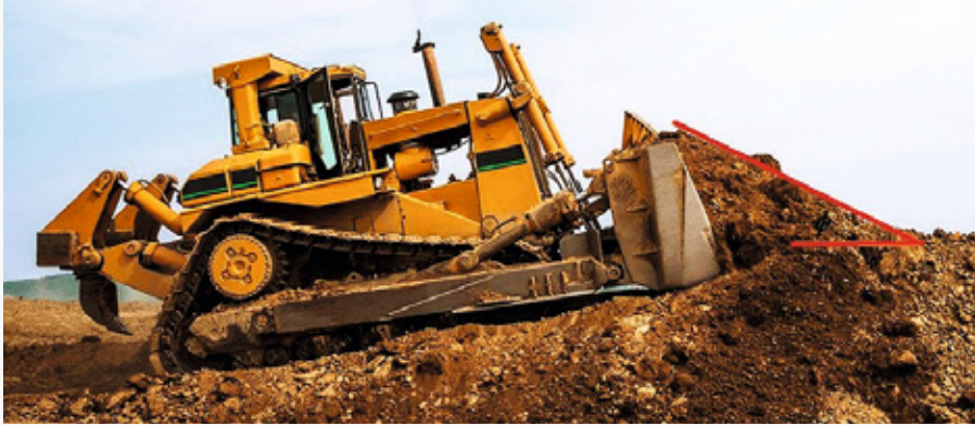
Slika 9. Formiranje vučne prizme ispred dozerskog noža (Zitzman, 2019)
