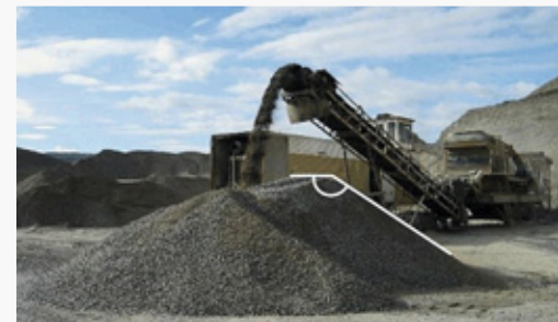
Slika 11. Odlagalište a) neklasirane mineralne sirovine b) klasirane mineralne sirovine (Urbano, 2011)
